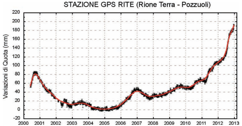
Figura 2. Deformazioni del suolo rilevate a partire dal 2000 tramite la rete GPS (componente verticale della stazione RITE Rione Terra).
