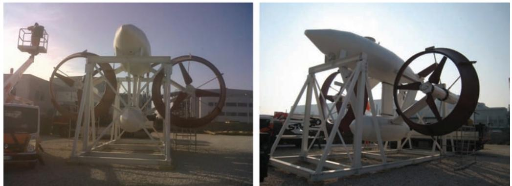
Il sistema reale ha due turbine con diametro di circa 3 metri per una potenza complessiva di 20 kW con una velocità della corrente di soli 1,5 m/s.
